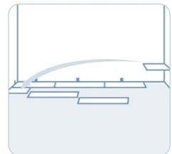
**Schritt ⑤** Die nächsten Dielen der zweiten – und übrigens auch aller folgenden Reihen – klickst Du schräg in einem Winkel von ca. 20 Grad in die vorherige Reihe längsseite ein. Das Kopfende verriegelst Du durch leichtes Klopfen mit einem Gummihammer von oben. Diesen Vorgang wiederholst Du, bis Du am Ende des Raumes gelangt bist.
