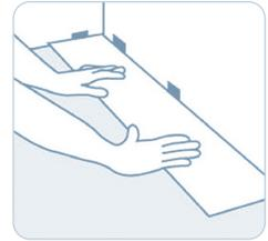
**Schritt ②** Anschließend wird die nächste Diele am Kopfende angeklickt. Durch ein leichtes Klopfen mit dem Gummihammer verriegelst Du die Verbindung, die Diele liegt dann eben auf dem Boden auf. Wiederhole das so lange, bis Du am Ende der ersten Reihe gelangt bist. Bitte achte darauf, dass die erste Reihe plan liegt. Am besten, Du beschwerst diese mit Gewichten.
